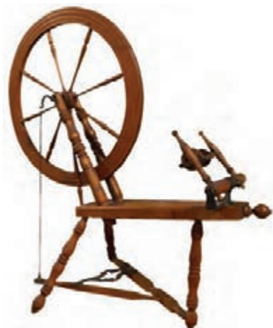
شکل ۲- دوک نخ ریشی دستی
