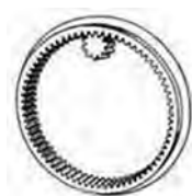
شکل ۴۱- چرخ‌دنده متداخل
