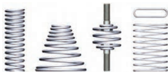
شکل ۴۷- انواع فنر فشاری
