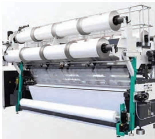
شکل ۲۵- ماشین بافندگی حلقوی تاری
