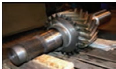
شکل ۳۹- نمونه‌هایی از چرخ‌دنده حلزونی
